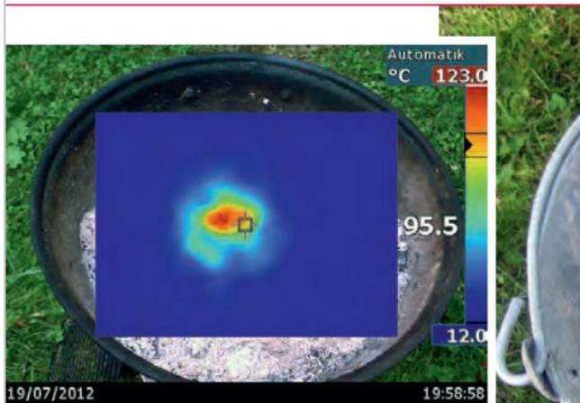
**Bild 10** | Einzelnes Glutnest in einem Aschebett nach etwa 25 Stunden Betrieb des Grills mit 2,5 kg Grillbrikett. Die Oberflächentemperatur auf der isolierenden Ascheschicht beträgt hier bis zu 123 °C. Unter dem „Hotspot“ muss sich ein Glutnest befinden.
